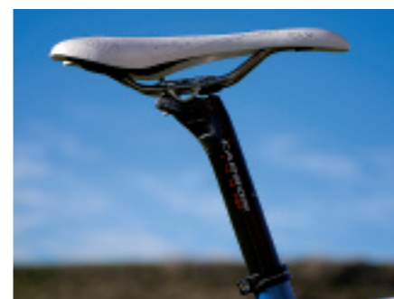
Die Simplon-Sattelstütze ist mit 185 Gramm sehr leicht, lässt sich aber schwer einstellen
